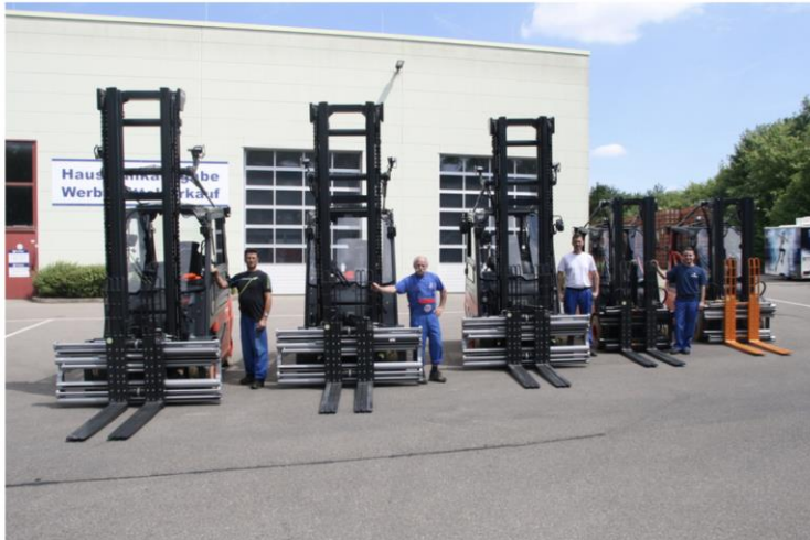
Ensinger ersetzte seine Propangas- durch Elektro stapler. Deren Batterien tragen dazu bei, Energie zu speichern und Lastspitzen auszugleichen. (Copyright: Ensinger)
